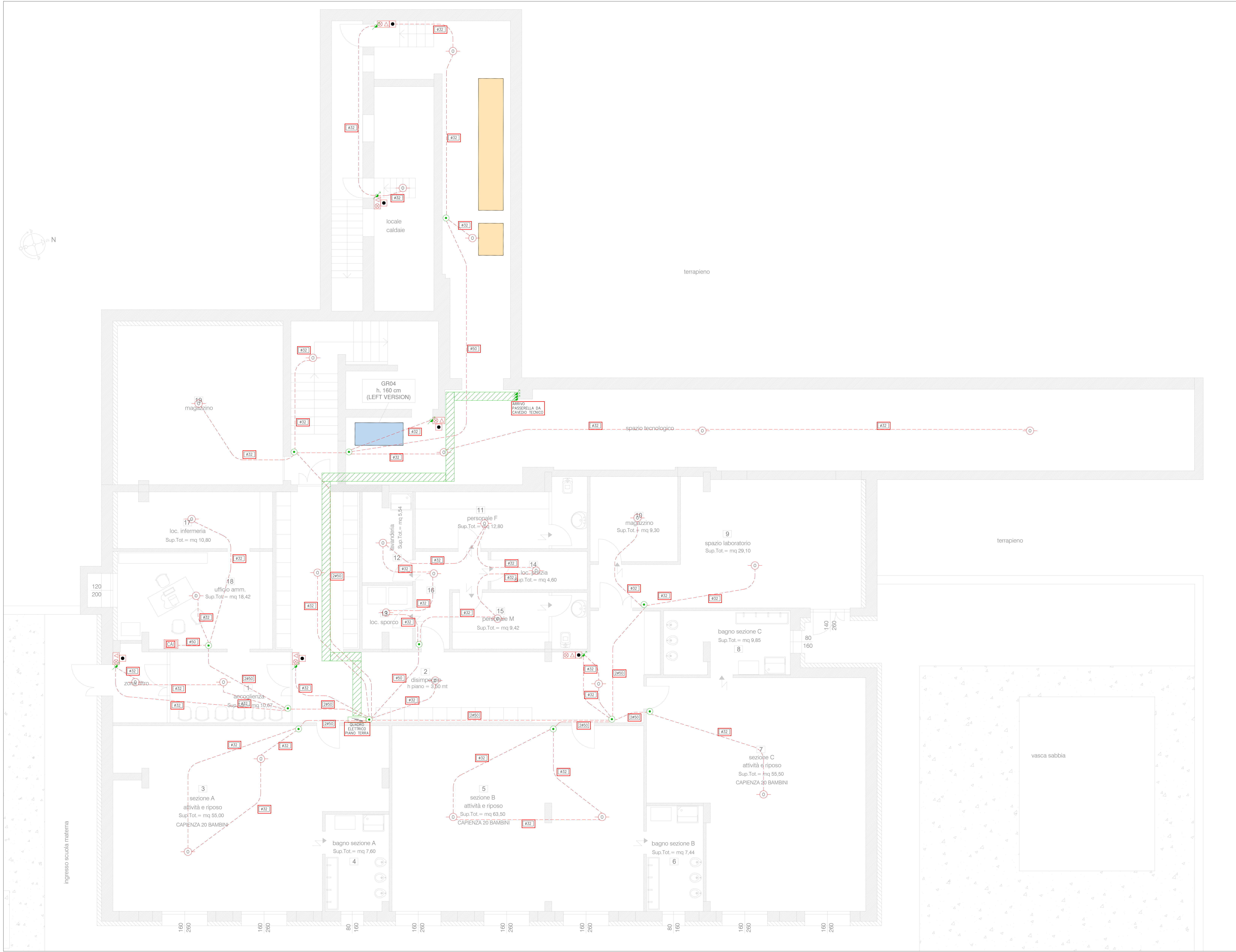
Planimetria piano terra - Impianti rivelazione fumi - scala 1:50
